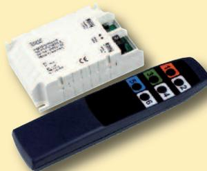
**LED Farbsteuergerät** mit IR-Fernbedienung über 6 Tasten. Steuerung der Farbwerte von LED-RGB, Einzelfarbsteuerung von rot, grün und blau oder unabhängige Helligkeitssteuerung von drei einfarbigen LED. Ein Farbspeicher, zwei feste Farbsequenzen mit Farbdurchlauf aller Lichtfarben. Versorgung 12 V bis 24 V-DC, max LED-Anschlussleistung 12 V-DC max. 30 W/ 24 V-DC max 60 W
