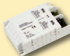
**LED Farbsteuergerät 'Slave'** zur Erhöhung der Systemleistung. Kompatibel zu allen oben aufgeführten LED-Steuergeräten. Das Signal des 'Master'-Gerätes wird am RGB-Eingang angeschlossen. Der Ausgang kann dann mit einer zusätzlichen 12 V-DC bzw 24 V-DC LED-Anschlussleistung belegt werden. Es erfolgt eine synchrone Farbsteuerung.
