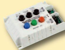
**LED Farbsteuergerät** manuell über 6 Tasten. Steuerung der Farbwerte von LED-RGB, Einzelfarbsteuerung von rot, grün und blau oder unabhängige Helligkeitssteuerung von drei einfarbigen LED. Ein Farbspeicher, zwei feste Farbsequenzen mit Farbdurchlauf aller Lichtfarben. Versorgung 12 V bis 24 V-DC, max LED-Anschlussleistung 12 V-DC max. 30 W/ 24 V-DC max 60 W
